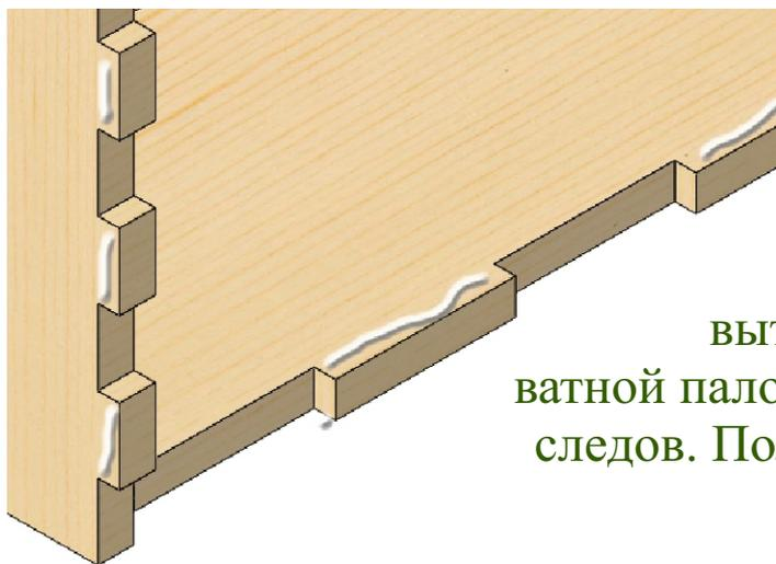
Клей наносится на боковую поверхность шипов с обеих сторон. Можете обмазать его весь, но не переусердствуйте! Соединив детали вытрите излишки клея куском ткани или ватной палочкой, после высыхания он не оставит следов. Положите изделие минут на 20 под груз либо сожмите струбцинами.
